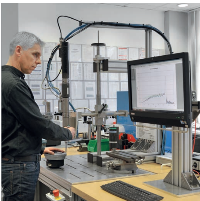
Einschraubtest am Prüfstand
